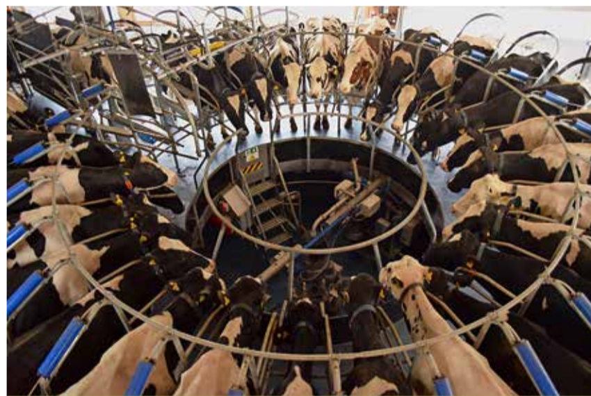
Le Roto E100 effectue une rotation complète en 8 à 12 minutes.
