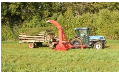
Récolte d'herbe pour compostage avec une récolteuse à fléaux
