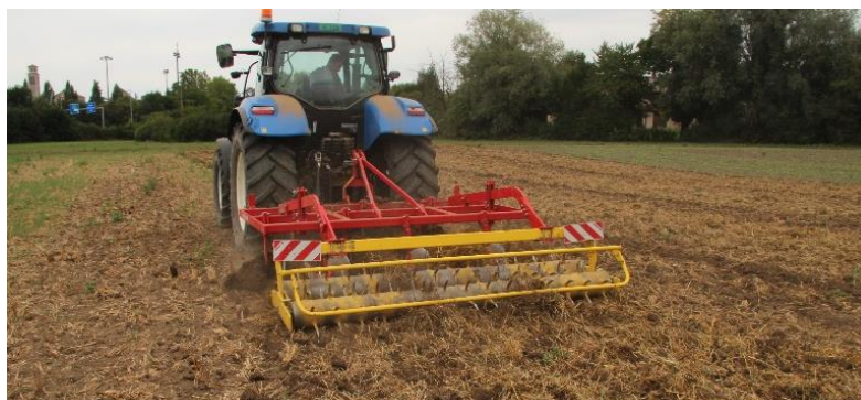
Déchaumage au Pottinger Synchro, avec des dents à ailettes recouvrantes
