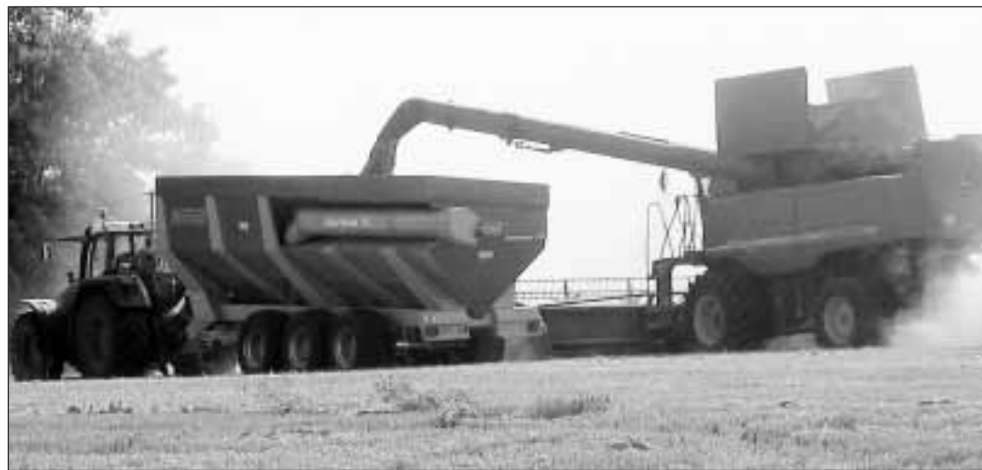
LES TRANSBORDEURS évitent à la machine d'avoir à s'arrêter pour vidanger.
