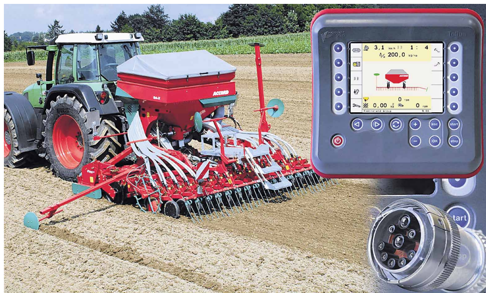
Isobus, rien d'autre en fait qu'un système de transfert de données standardisé.
