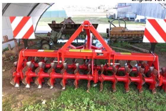
Machine utilisée pour l'enfouissement de l'engrais vert
